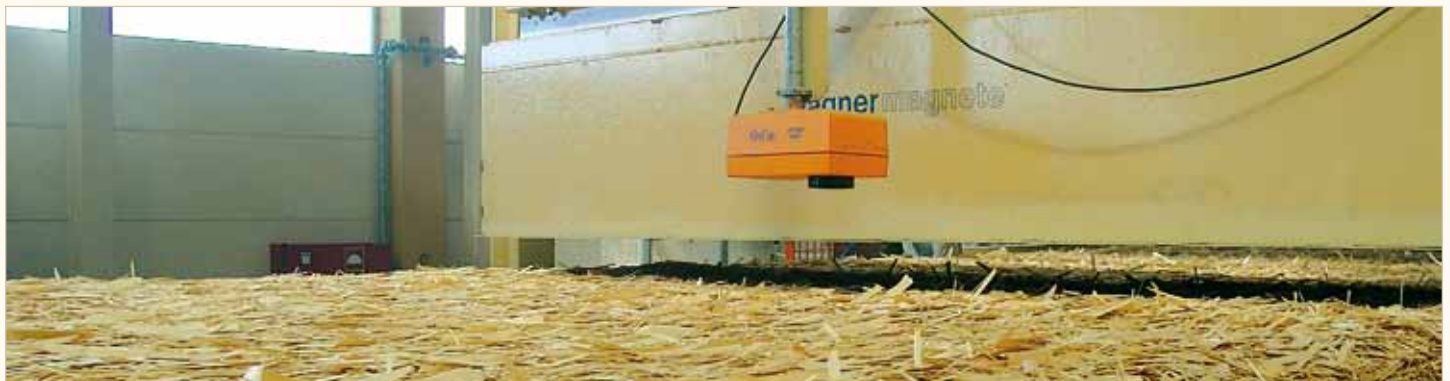
Feuchtemessung hinter der Formstraße
