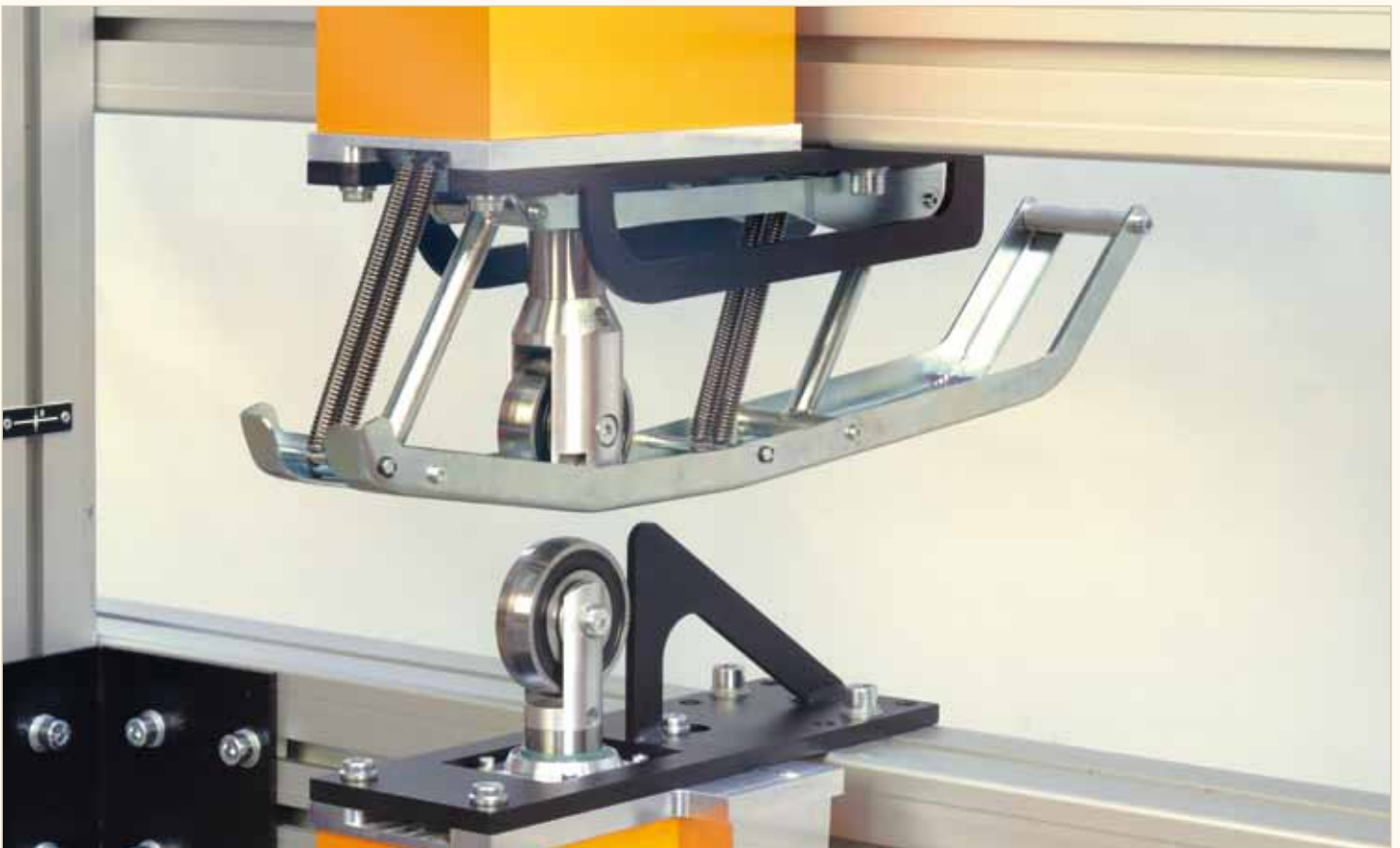
Berührende Messung mit ct-Messrahmen
