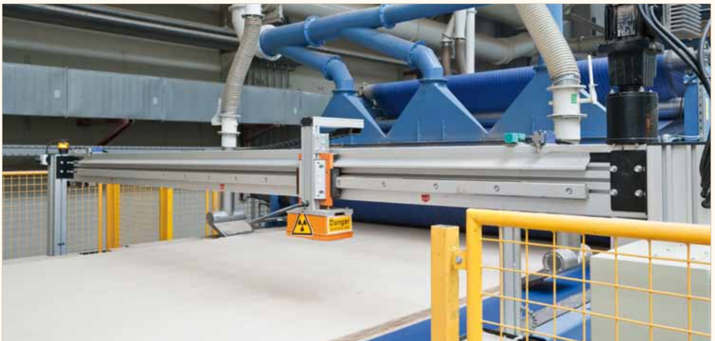
Messung einer Span-Matte
