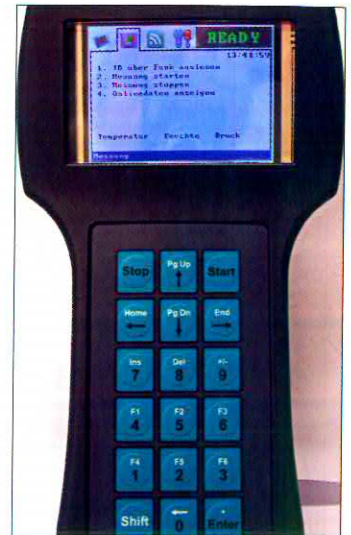
Abb. 5 Lesegerät zum Bedienen und Auslesen der Messdaten des Conti Logs
