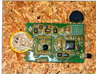
Abb. 3 „Conti Log“ zur Messung von Temperatur und Gasdruck in der Heißpresse
